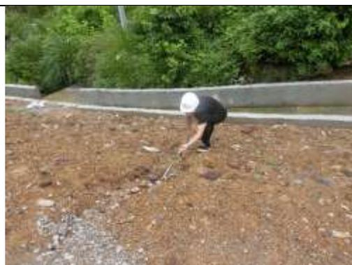
图 1-8 路堤边坡侵蚀沟量测
